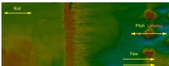
Se realizan las pruebas de calibración, que consisten en la medición de los desvíos del origen de medición del balanceo, cabeceo y guiñada, a partir de la captura de datos siguiendo unas líneas de navegación que combinen zonas de poco relieve con otras de cierto desnivel.
