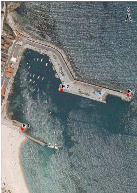
En la planificación se decide también el método de posicionamiento adecuado. Éste debe referirse a puntos de una Red Geodésica adecuada, debidamente establecida y referenciada (Vértices Geodésicos), o en puntos específicos coordinados para tal efecto (Puntos de Apoyo). El posicionamiento geográfico es obtenido entonces mediante la utilización de un rover GNSS RTK que recibe la señal diferencial procedente de una base en tierra o de una red GPRS local.
