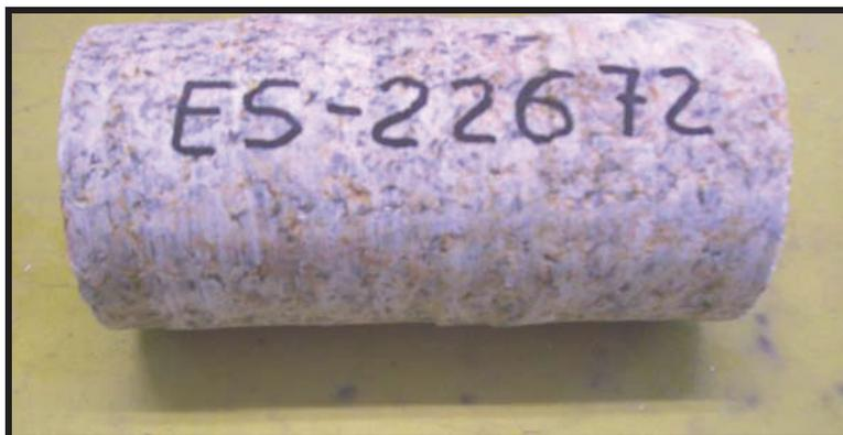
Detalle de testigo tallado en sustrato granítico grado III.
