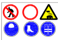
SEÑALIZACIÓN A COLOCAR EN ACCESO DE VEHÍCULOS
