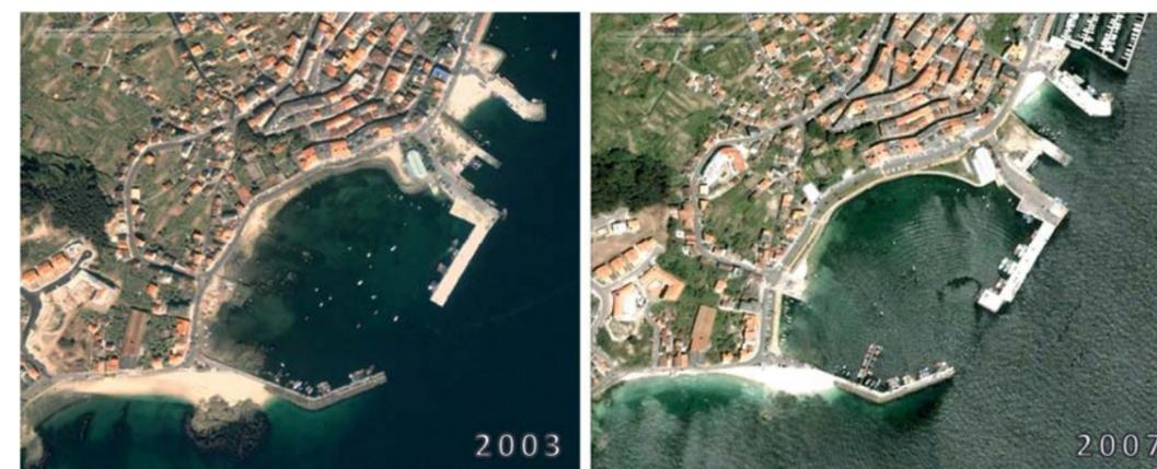
Figura 2. Fotografías aéreas de los años 2003 y 2007 (sin y con la construcción de la primera fase del dique)
