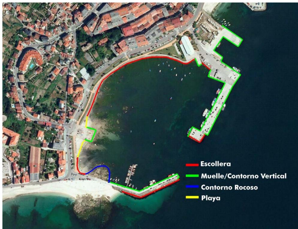
Figura 12. Contornos utilizados en el modelado.
