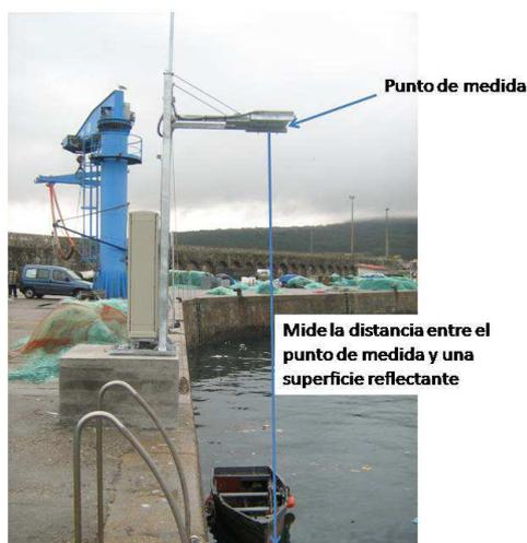
Figura 1.- Detalle de la instalación del radar MIROS en el puerto de LAXE.
