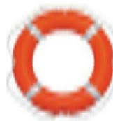
**Especificaciones técnicas.-** Fabricado en polietileno, de color naranja, con 4 tiras de reflectantes, imputrescibles, resistente a situaciones y ambientes extremos agresivos, y de forma toroidal, y con dimensiones  $\varnothing_{\text{exterior}}$  73 cm., y  $\varnothing_{\text{interior}}$  44 cm., y peso de 2,50 kg.
