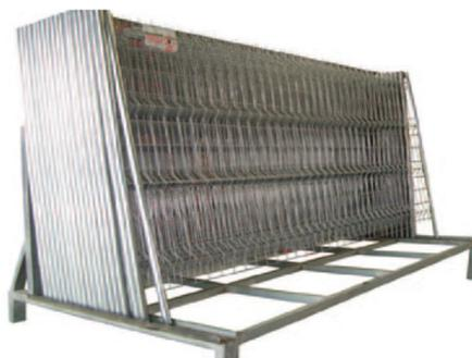
**Especificaciones técnicas.-** Módulo de longitud variable, entre 1,00 y 2,50 m., formado por 2 tubos laterales, de acero galvanizado de  $\varnothing$  40 mm., sobre los que va soldado el mallazo de alambre de acero galvanizado de  $\varnothing$  5 y 4 mm., plegado longitudinalmente.
