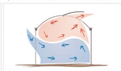
Ventilación lateral y cenital
