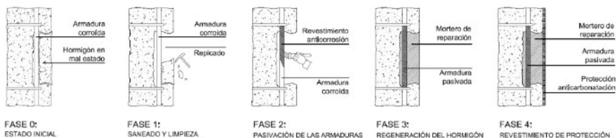
Figura 4: Fases de la reparación de pilares con armadura corroída
