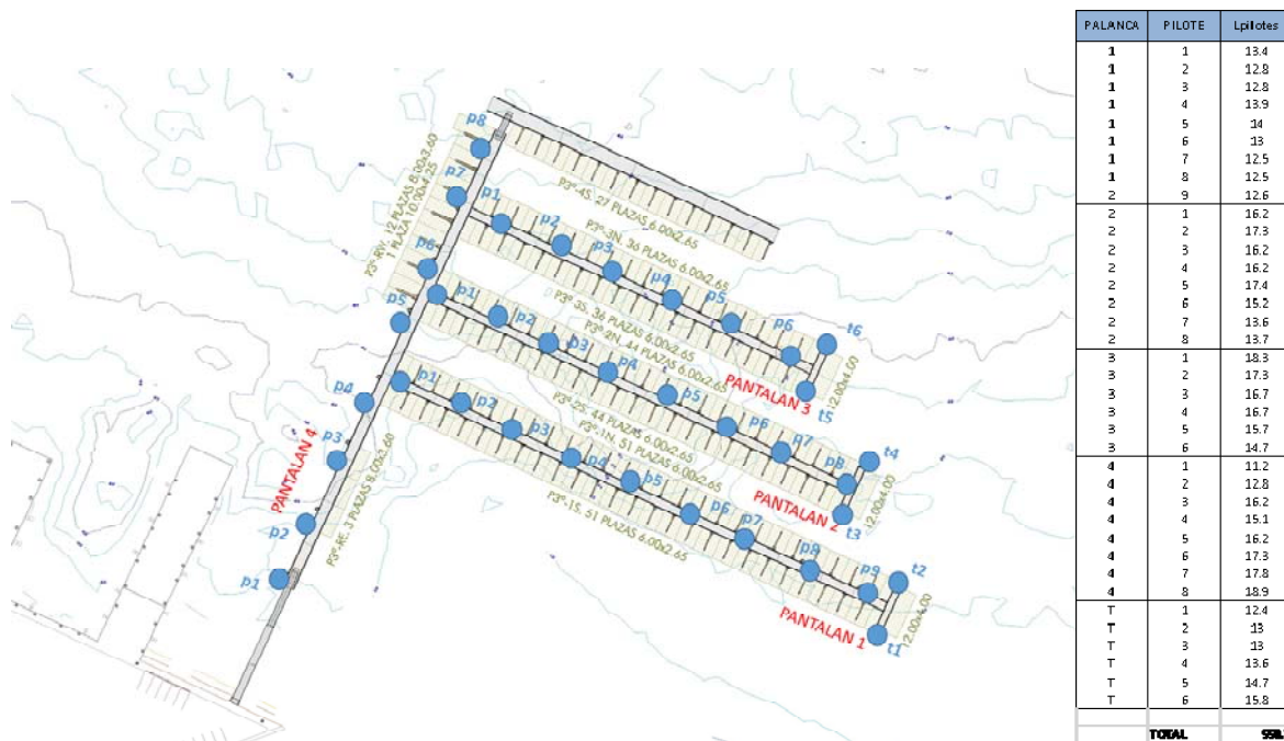
Figura 13. Esquema y longitud de pilotes
