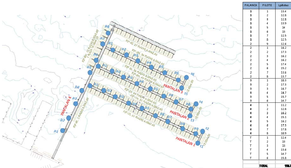
Figura 10. Esquema y longitud de pilotes
