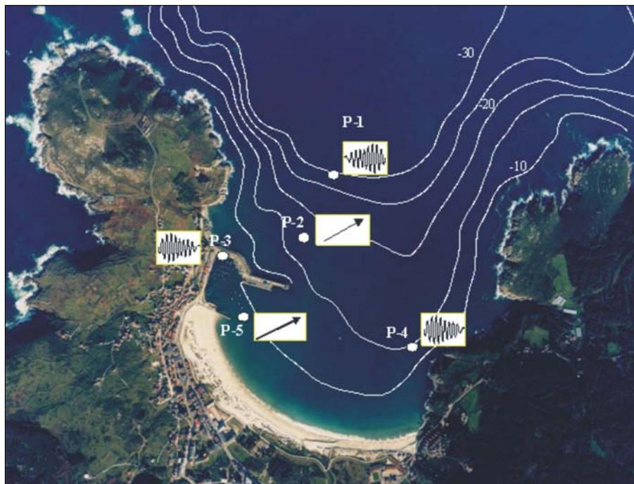
Figura 4.1 – Puntos de ubicación de los equipos de medida.
