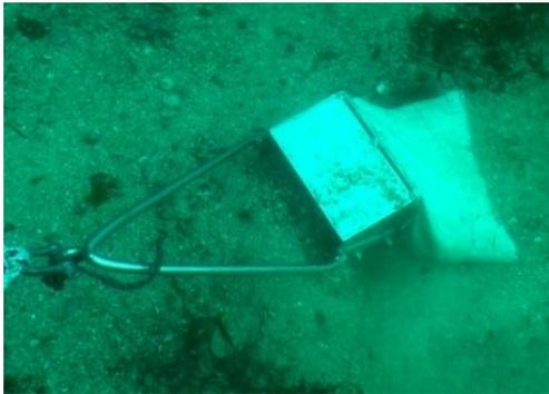
La recogida de las muestras se realizó con una draga semicuantitativa Foster. Se trata de una draga de arrastre, de boca rectangular unida a un saco ciego, con capacidad de 28 litros. Con ello se consigue extraer una muestra, tanto del sedimento, como de la macrofauna asociada. Es una de las dragas más utilizadas en cartografías bentónicas del
