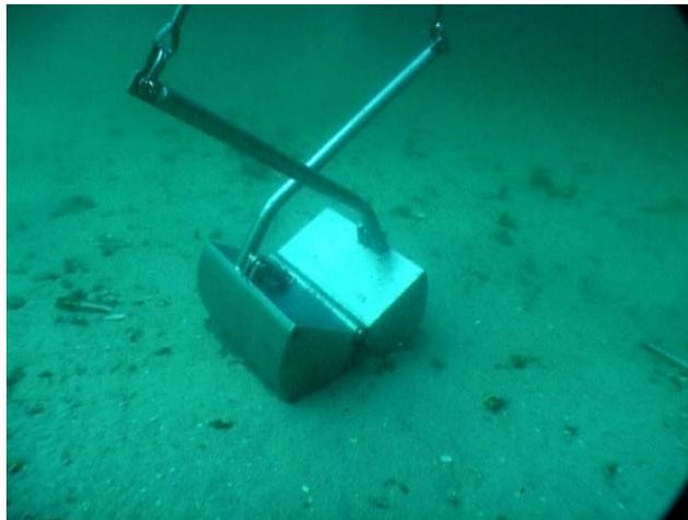
Del volumen de sedimento así recogido, se separa en una bolsa una submuestra para granulometría (a través del sistema norma ASTM), caracterización físico-química y el resto se tamiza con una luz de malla de 1 mm.
