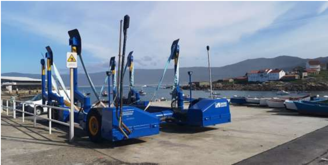
Imagen 13. Detalle del sublift del que se dispone en el puerto de Portocubelo. Fuente: ACADAR
