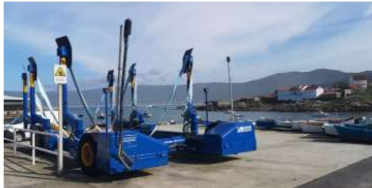
Figura 8. Sublift utilizado para el servicio de varada de embarcaciones en el puerto de Portocubelo. Fuente: ACADAR
