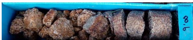
Foto 5.- Detalle de las características visuales del granito en la zona del sondeo S-2, justo después del contacto con el jabre.
