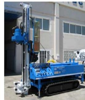
Para la ejecución de este sondeo se ha utilizado una máquina marca ROLATEC RL-48, propiedad de EPTISA, con capacidad para alcanzar profundidades de hasta 100 m aproximadamente.
