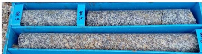
Foto 4.- Detalle del sustrato granítico en la zona del sondeo S-1
