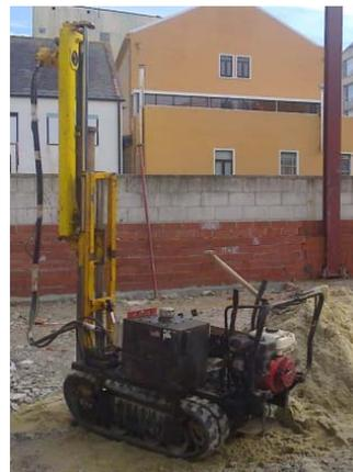
Este ensayo consiste en hacer penetrar en el terreno una puntaza ciega mediante el golpeo de una maza de 63,5 Kg. de peso, que cae en caída libre desde una altura de 50 cm., con el objeto de medir el número de golpes que se requiere para conseguir una penetración en el terreno de 20 cm. El ensayo finaliza cuando tras varias andanadas de 100 golpes no se consigue el intervalo de 20 cm de penetración.
