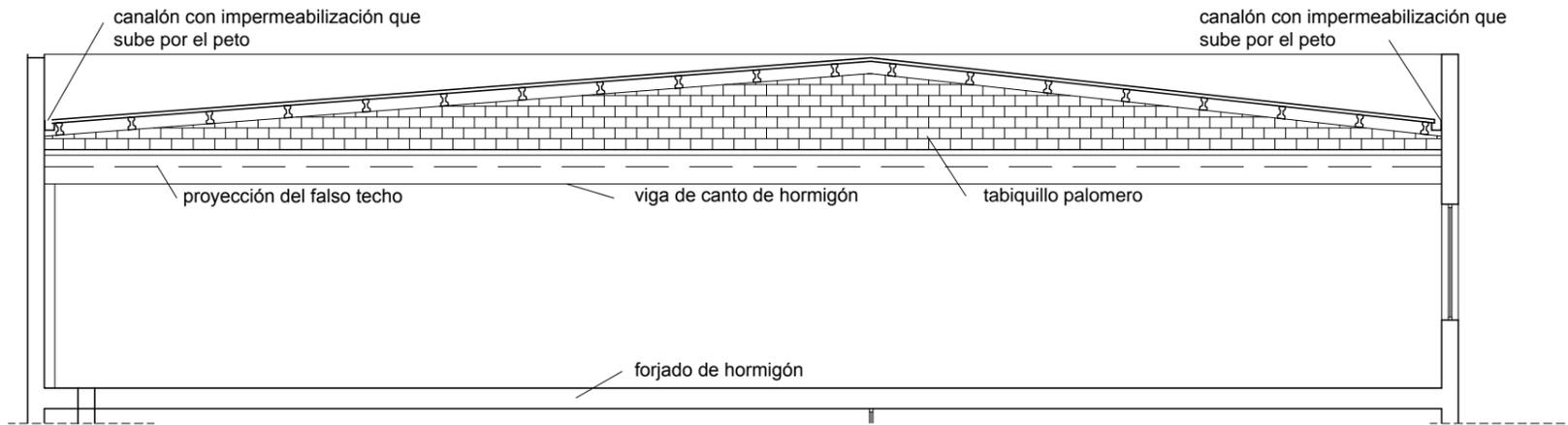
SECCIÓN AA': FORJADO DE HORMIGÓN CON TABIQUILLOS PALOMEROS
