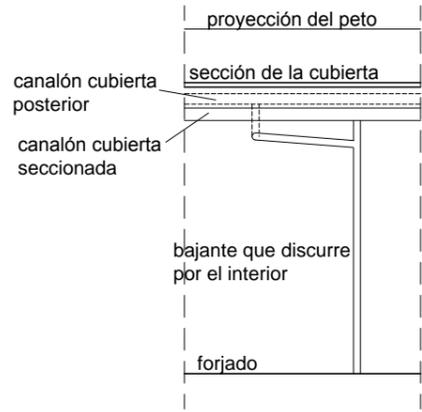
ESQUEMA ORIENTATIVO EVACUACIÓN DE PLUVIALES
