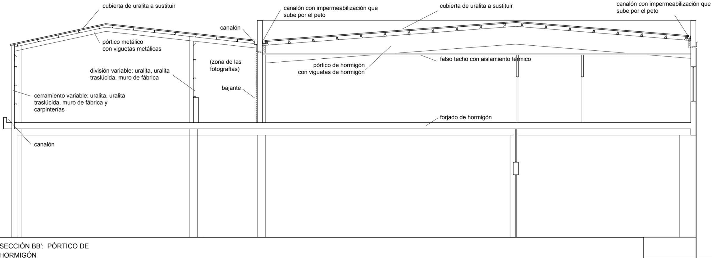
SECCIÓN BB': PÓRTICO DE HORMIGÓN
